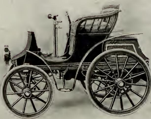
Moteur de quatre chevaux et demi. — Transmission par une seule courroie.
